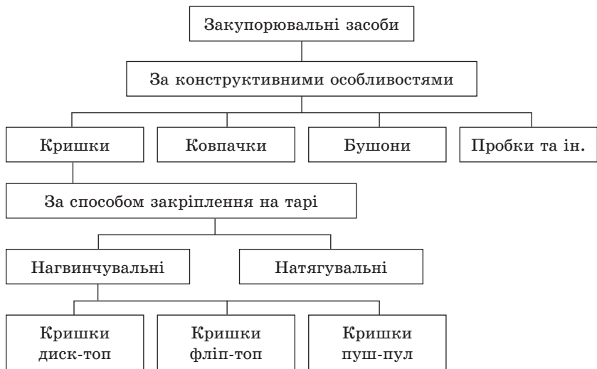
Рис. 3. Приклад ієрархічного методу класифікації закупорювальних засобів
