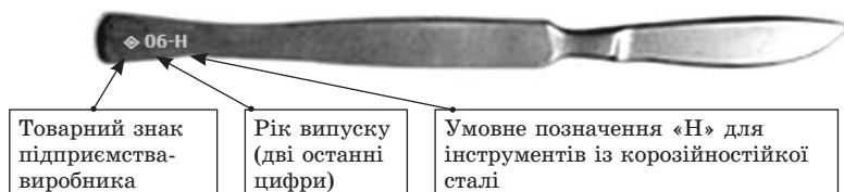
Рис. 60. Маркування медичного металевого інструмента
