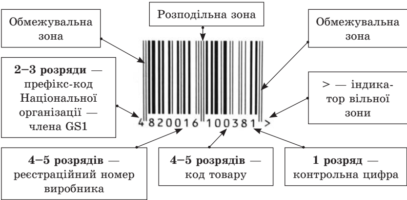
Рис. 6. Структура коду EAN-13
