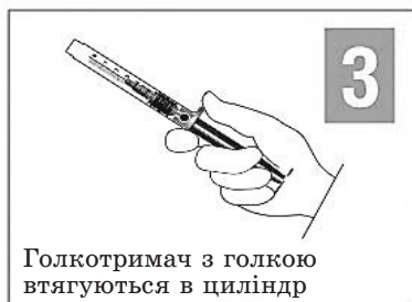
Рис. 90. Схема роботи самоблокувального одноразового шприца
