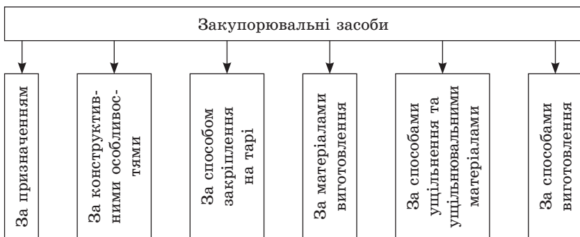
Рис. 2. Приклад фасетного методу класифікації закупорювальних засобів
