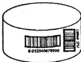
Рис. 11. Приклад розміщення штрихкової позначки на вигнутій поверхні з кутом кривизни менше 30°
