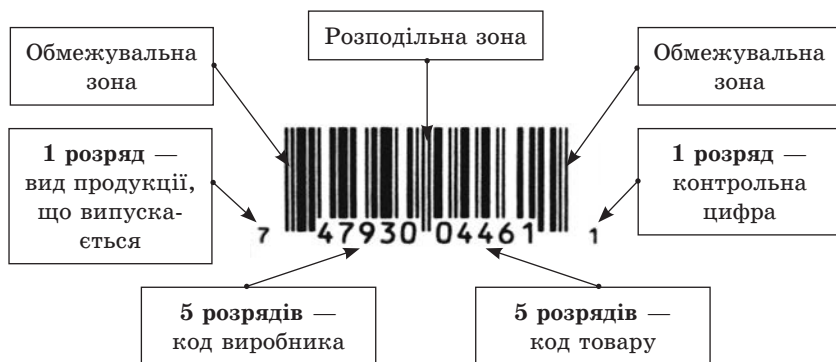
Рис. 4. Структура коду UPC-A
