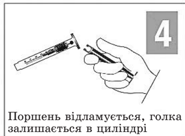
Рис. 90. Схема роботи самоблокувального одноразового шприца
