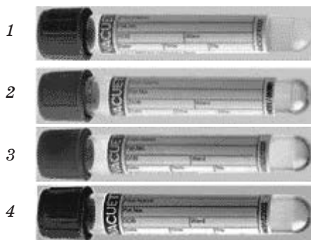
Рис. 97. Кольорові пробірки: 1 (зелена) — вакуумна пробірка для плазми; 2 (синя) — вакуумна пробірка для коагулології; 3 (червона) — вакуумна пробірка для сироватки; 4 (фіолетова) — вакуумна пробірка для гематології
