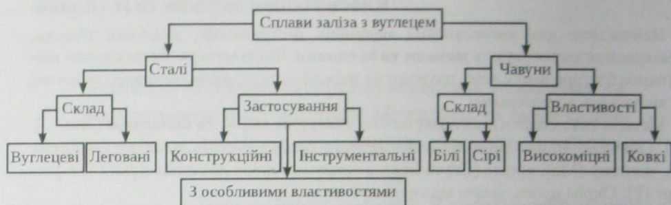
Рис. 3.3. Класифікація сплавів заліза з вуглецем.
