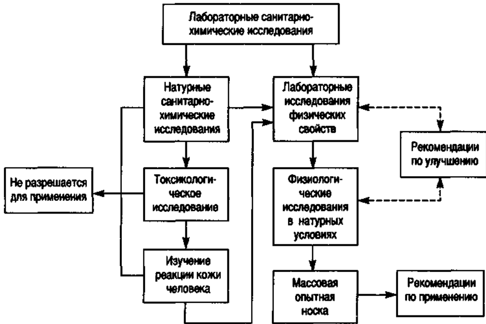
Рис. 14.1. Схема проведения исследований по гигиенической оценке одежды из синтетических материалов (по К.А. Рапопорту, 1971).
