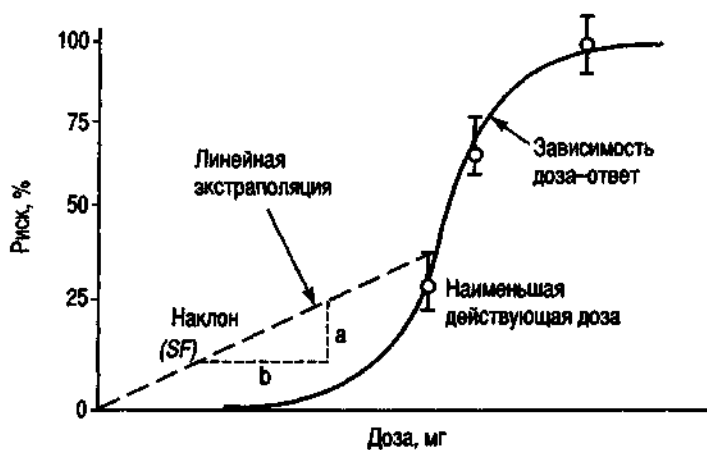
Рис. 3.10. Установление факторов канцерогенного потенциала.
