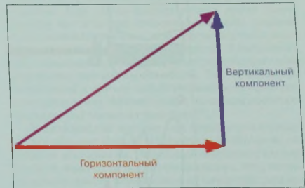
Рис. 1-6 Векторные компоненты. Вектор можно проанализировать, разложив его на компоненты по осям.
