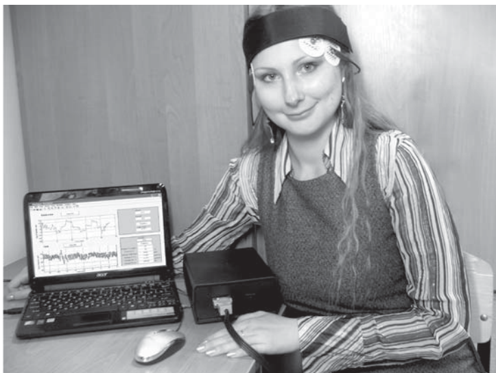
Рис. 1. Внешний вид аппаратно-программного комплекса для электронистагмографии
