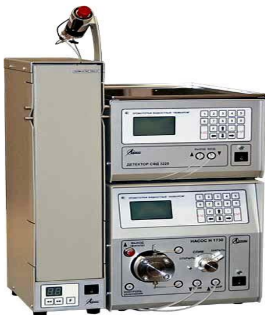
Рисунок 6 – Рідинний хроматограф «ЛЮМАХРОМ ®»
