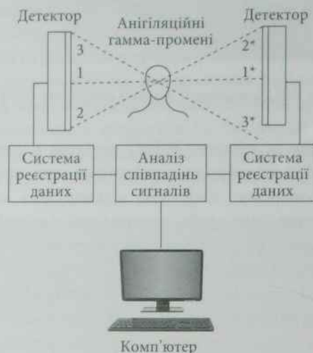
Рис. 9.7. Схема двофотонної емісійної позитронної томографії
