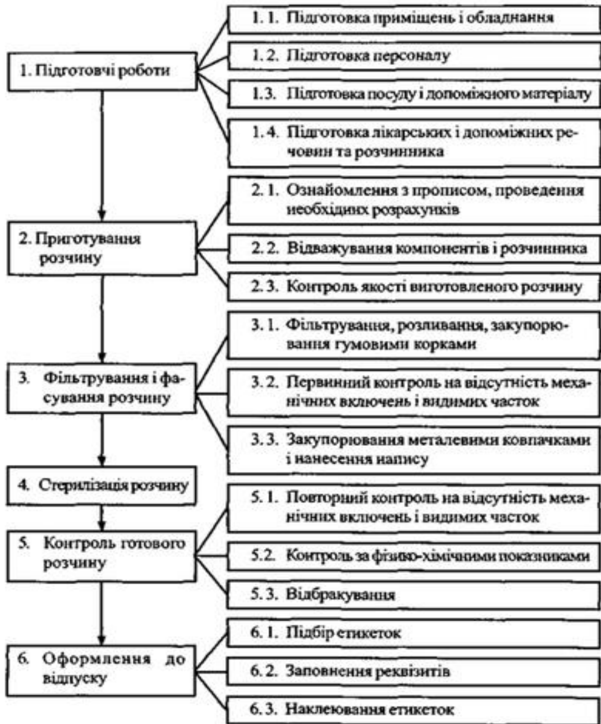
Схема 7.2. Етапи виробничого процесу серійного виготовлення стерильних розчинів
