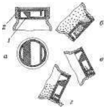
Рис. 3. Дозатор для порошку з фігурними перегородками: а — загальний вид дозатора; б — перший поворот для засипання проміжної камери; в — другий поворот для засипання дозувальної камери; г — третій поворот для видачі дози порошку; 1 — пробка з перегородками; 2 — герметизаційна кришка
