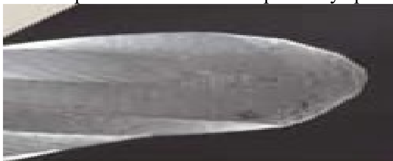
Неагресивний кінчик інструменту ProTaper Universal
