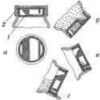
Рис. 3. Дозатор для порошку з фігурними перегородками: а — загальний вид дозатора; б — перший поворот для засипання проміжної камери; в — другий поворот для засипання дозувальної камери; г — третій поворот для видачі дози порошку; 1 — пробка з перегородками; 2 — герметизаційна кришка
