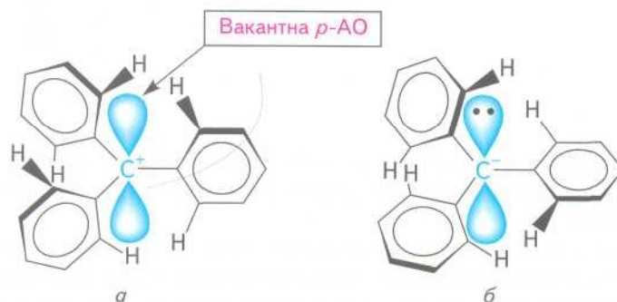
Рис. 16.1. Просторова будова: а — трифенілметил-катиона; б — трифенілметил-аніона
