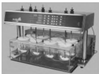
Мал. 3 Установа для тестування на розчинення таблеток і капсул виробництва Pharmatest (Германія) модель РТWS 3СЕ
