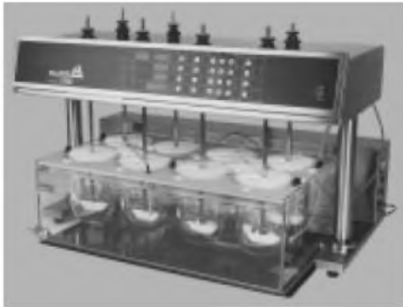
Рис. 3 Установа для тестування на розчинення таблеток і капсул виробництва Pharmatest (Германія) модель PTWS 3CE
